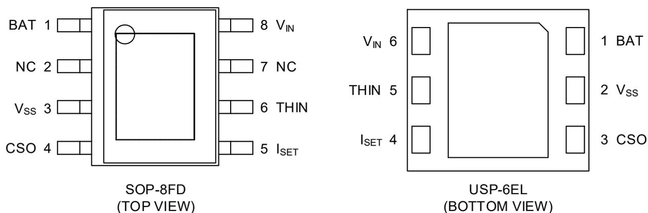
\* USP-6EL の放熱板は実装強度強化および放熱のため、参考パターンレイアウトと参考メタルマスクではんだ実装を推奨しております。
