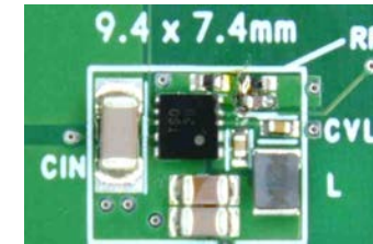
60V 300mA DC/DC : XC9702 世界最小级别尺寸的解决方案 9.4mm x 7.4mm = 69.6mm 2
